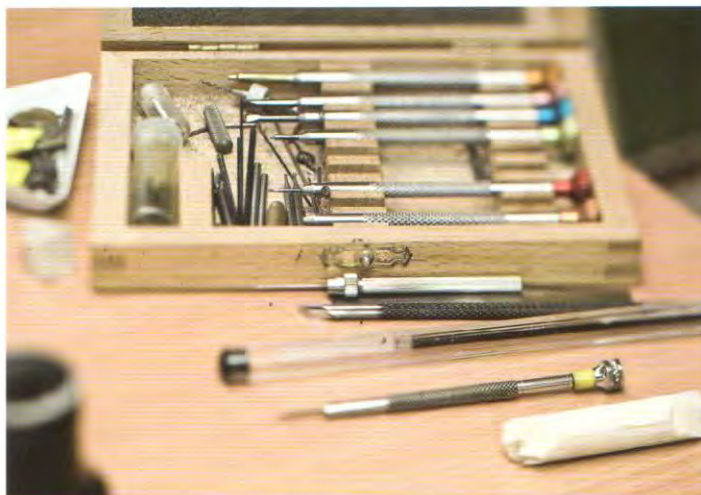
Masterpiece-Werkzeug: Federstegwerkzeuge und Stiftenkloben in allen Größen.
